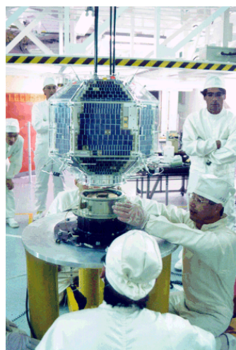
分離機構取付
